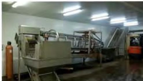
Le transfert des produits dans la salle de traitement se fait par tapis convoyeur et chute à eau de mer.
