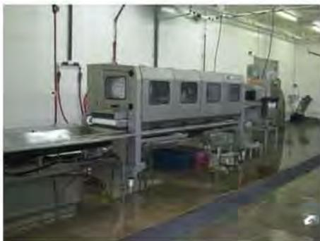
Une machine à trancher le poisson blanc (cabillaud, lieu, églefin) de type Baader 541 et une étêteuse de type Baader IS033 acquises neuves en 2013, propriétés de la SIFPA ; équipement en location simple auprès de la SNPM (voir annexe 2)
