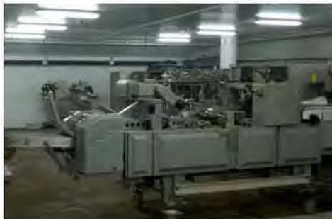
Machine à fileter le poisson blanc (cabillaud, lieu, églefin) de type Baader 252 acquise d'occasion en 2015, propriété de la SNPM ; est associée à cette machine une étêteuse de type Baader 417 d'occasion, propriété également de la SNPM (provenance de l'usine de Saint-Pierre avec une seconde 417 de secours)
