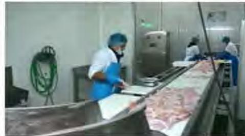
Est associé à la sortie du tunnel IQF un ensemble d'équipement de glazurage, convoyage et conditionnement simple, propriétés de la SNPM.
