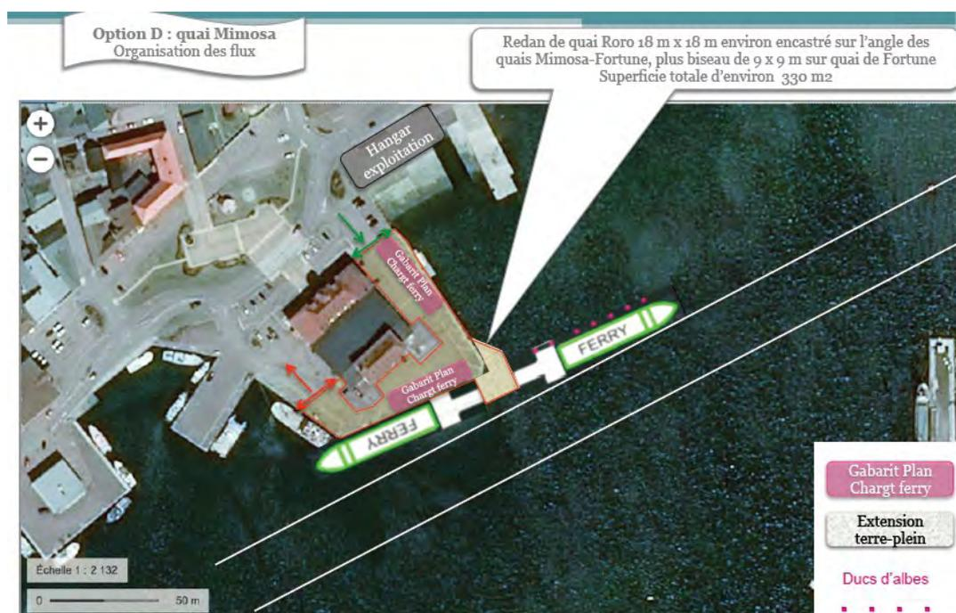
**figure 5** : Proposition d'installation d'un redan permettant la fixation des rampes d'embarquement et des quais flottants (photo : Cabinet Conseil Earthcase).
