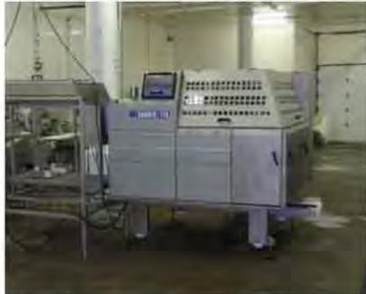
Machine à fileter le poisson plat de type Baader 176 et un équipement annexe servant à éviscérer le poisson plat avant filetage de type Vacuum (Baader), matériel acquit neuf en 2009, propriété de la SODEM, sous contrat de location-vente avec la SNPM (voir annexe 2)
