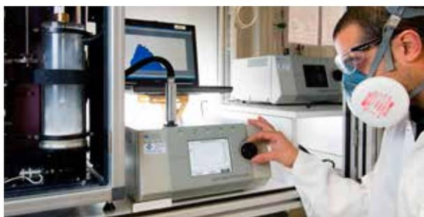
Plateforme MONA du LNE pour la métrologie des aérosols qui permet de caractériser des nanopoudres en continu en taille et en nombre.
