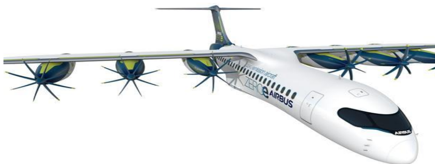
Figure 16 : Concept d'avion hydrogène imaginé par Airbus équipé de 6 pods rechargeables placés sous les ailes 162 - Source Airbus reproduit par le Figaro
