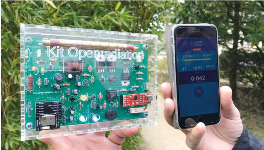
Le dispositif Openradiation permet à tout citoyen muni d'un capteur et d'un smartphone de réaliser des mesures de la radioactivité dans l'environnement.
