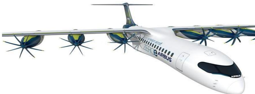
**Figure 7** : Concepts d'avion hydrogène imaginé par Airbus équipé de 6 pods rechargeables placés sous les ailes<sup>31</sup>.
